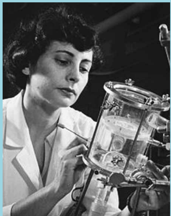
Figura 2. Nina Braunwald, M.D., ajustando una cámara de prueba para prótesis valvulares cardíacas.
