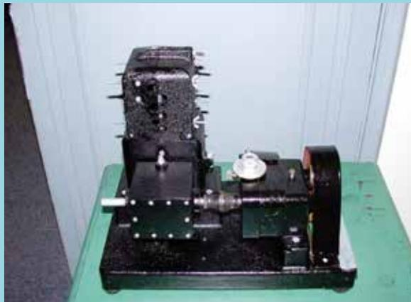
*Bomba Sigma Motor. Consistía en un motor eléctrico con regulador de velocidad mecánico (a la derecha de la estructura), que permitía impulsar un líquido, en este caso sangre, comprimiendo en forma secuencial un tubo de látex o silástico ubicados en la parte alta de la máquina, la que se abría para pasar los tubos. Su uso original era para la industria lechera, para ordeñar las vacas lecheras. Era eficiente, pero muy ruidosa.*
