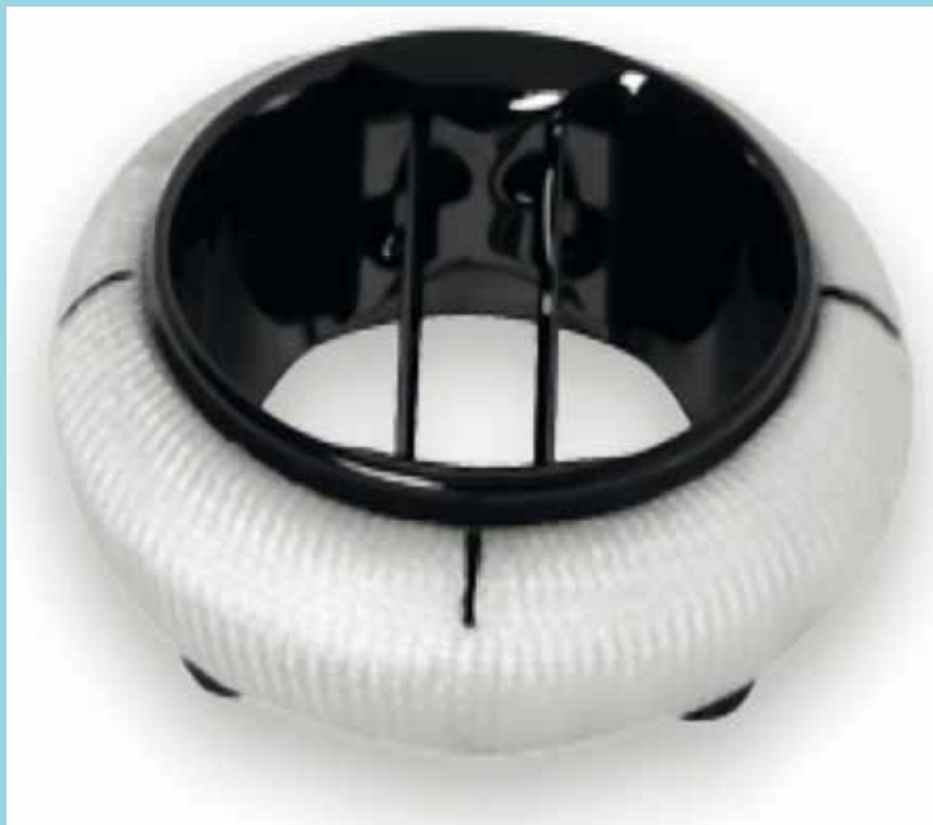
Figura 4. Prótesis mitral OnX Conform. Se observa verdadero "cilindro" de grafito dentro del cual se mueven las valvas protésicas y el extenso cojinete de sutura de PTFE (OnX life technologies Inc. USA).
